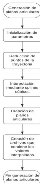
Figura 7 . Diagrama de flujo modo control. Fuente: los
