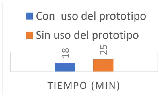
gráfica 10. Tiempos de realización del manteniendo con y sin el dispositivo inalámbrico
