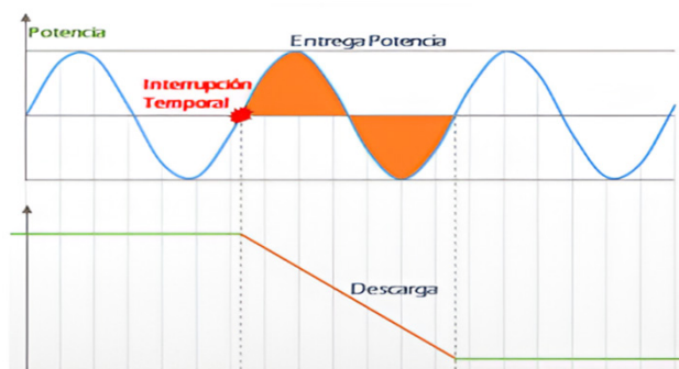
Figura 6. Sistema de almacenamiento para regulación de voltaje.
