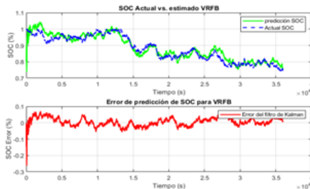
Figura 10. Resultado de tercera ejecución del código para batería de flujo redox.
