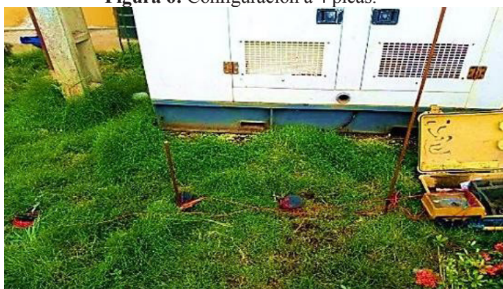
Figura 6: Configuración a 4 picas.
